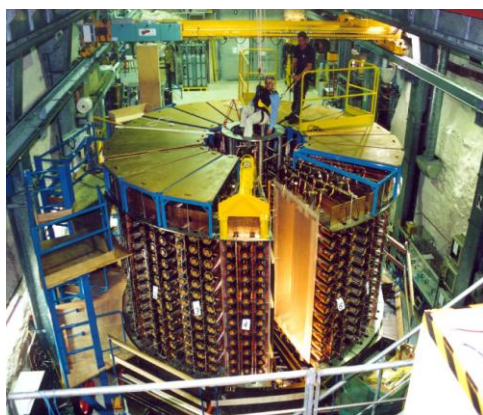
Le détecteur NEMO3 pendant son installation au Laboratoire Souterrain de Modane
