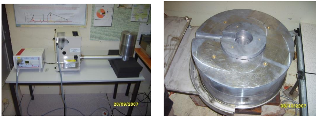
Fig. 1 : Détecteur Ge planaire ultra-bas bruit de fond développé par le groupe LSM
