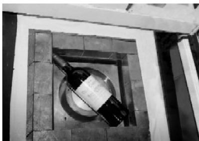
**Figure 3 :** Mesure non-destructive : installation de la bouteille de vin sur le détecteur.
