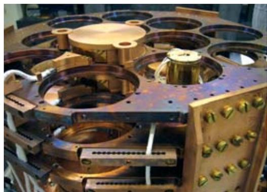
Détail du montage des étages de détecteurs de l'expérience Edelweiss dans le Laboratoire souterrain de Modane.
