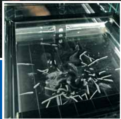
Art contemporain ? Non, traces de double alphas dans une chambre à brouillard. ©L.S.
