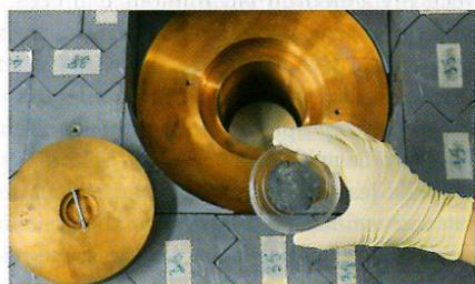
Les échantillons à analyser sont disposés sur les détecteurs au germanium dans des cuves blindées au cuivre et au plomb. Les chercheurs utilisent un très vieux plomb romain du 5<sup>e</sup> siècle, qui a ainsi perdu sa radioactivité naturelle.
