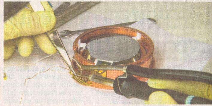
Au milieu du tunnel routier de Fréjus, les scientifiques de l'expérience Edelweiss II préparent le cryostat (au centre), qui doit refroidir à  $-273^{\circ}\text{C}$  les détecteurs composés de germanium et cerclés de cuivre (à droite). IN2P3
