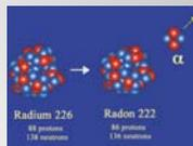
**Rayonnement  $\alpha$**  : Le noyau recherche la stabilité en émettant un noyau d'hélium ou particule **alpha**. La particule alpha est arrêtée par une simple feuille de papier.
