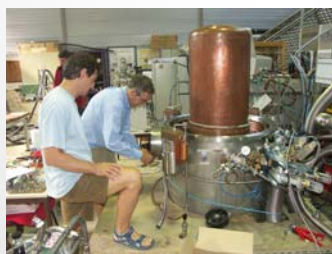
A l'intérieur de ce gros capot en cuivre : les détecteurs.
