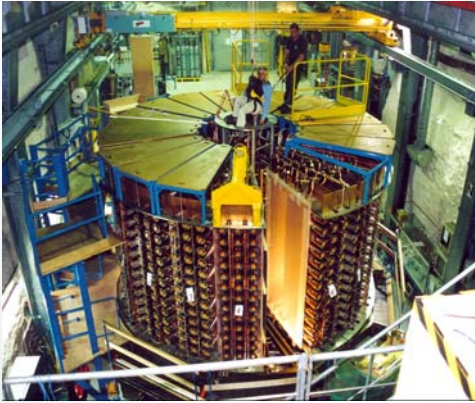
Le détecteur NEMO en cours de montage Neutrino Ettore Majorana Observatory
