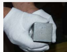
La première brique ! Purifié et fondu, le plomb romain protège maintenant les détecteurs ultra sensibles d' EDELWEISS.
