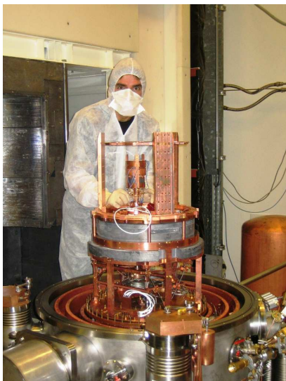
Montage des premiers détecteurs de test sur la platine du cryostat ouvert. © CEA/Dapnia
